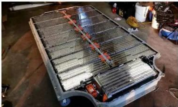
特斯拉Model S电池模组为16个
