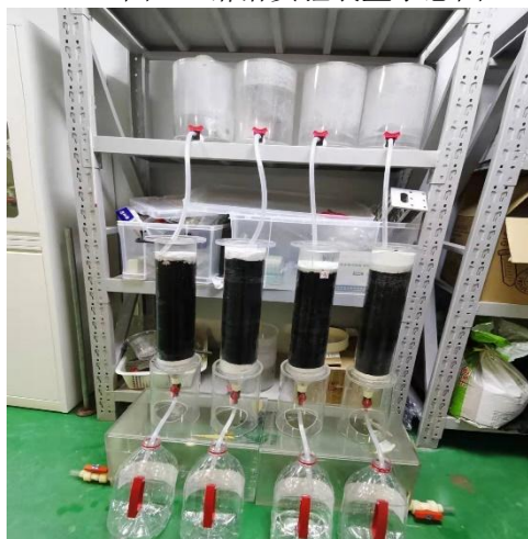
图 2-5 淋溶实验现场图
